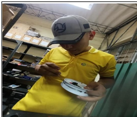
MANTENIMIENTO SENSORES DE HUMO
