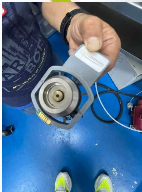
Figura 6. Técnico verificando el estado del cátodo — punto oscuro central visible indicador de desgaste
