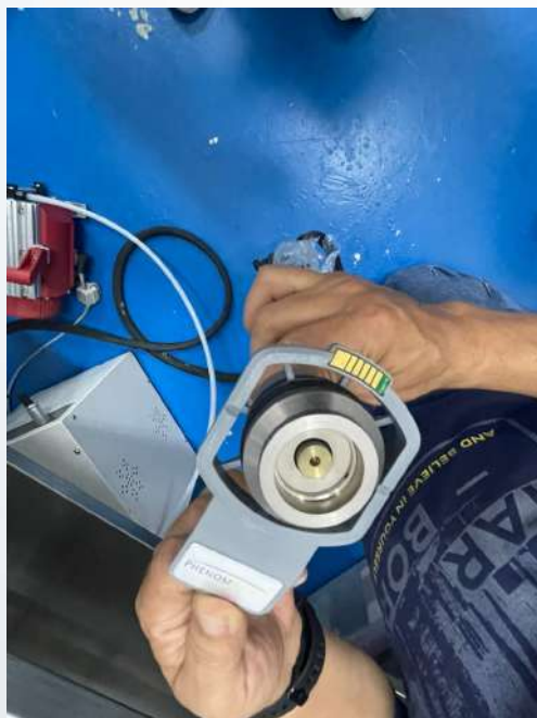
Figura 3. Extracción del portamuestras — vista frontal del cátodo \text{LaB}_6 y chip de identificación
