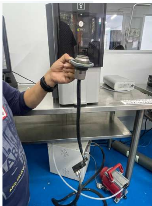
Figura 6. Técnico verificando el estado del cátodo — punto oscuro central visible indicador de desgaste
