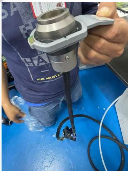
Figura 5. Portamuestras con conjunto de tubería del Deben CoolStage
