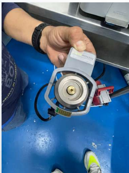
Figura 5. Portamuestras con conjunto de tubería del Deben CoolStage
