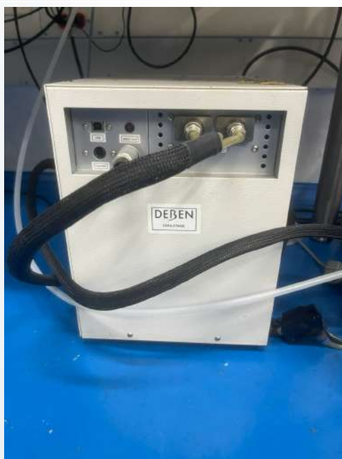
Figura 9. Unidad controladora Deben CoolStage — panel de conexiones: USB, Water Level, Controller, manguitos de refrigeración
