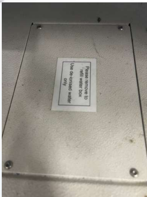
Figura 11. Etiqueta de instrucción de fabricante: uso exclusivo de agua desionizada para relleno del depósito
