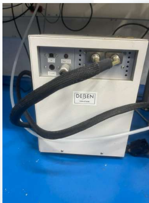
Figura 10. Vista frontal del CoolStage — estado de conexiones y manguitos verificados sin fugas
