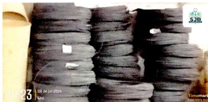
Ilustración 32 Material de acero (alambre negro ordenado). Fuente: elaboración propia
