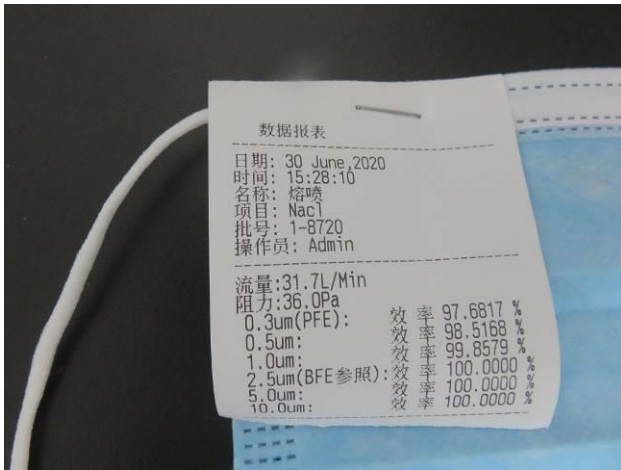
Prueba de filtración
