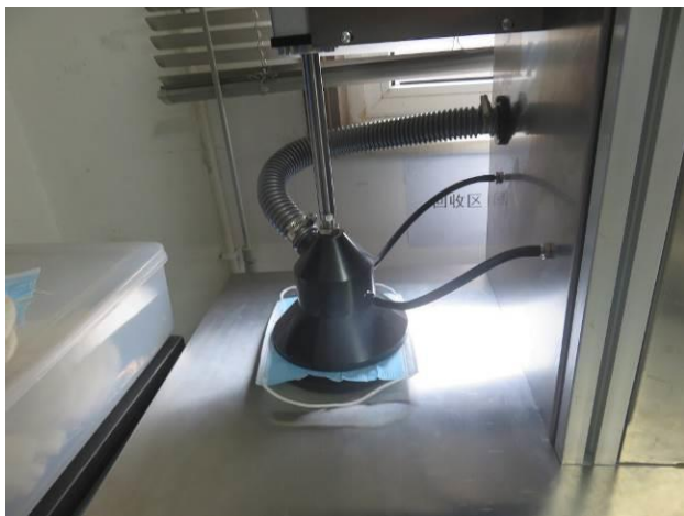
Prueba de filtración
