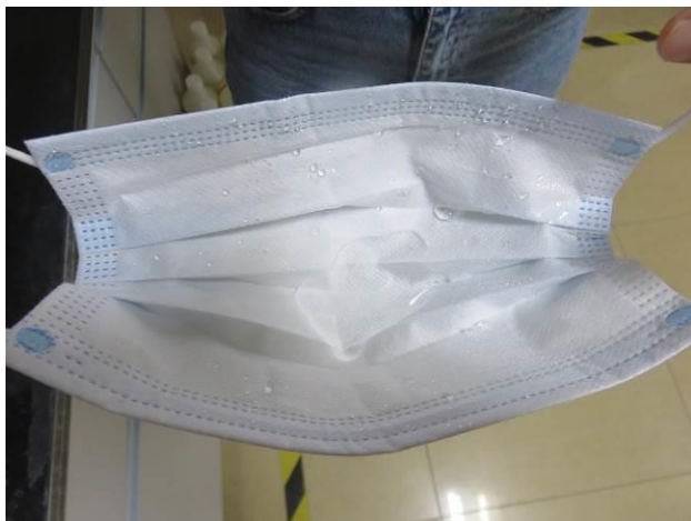
Prueba de impermeabilidad
