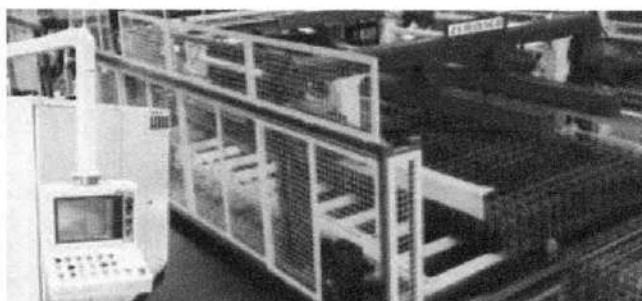
Máquina para producción de Malla Electrosoldada
