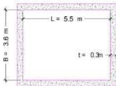
Planta tanque de almacenamiento
