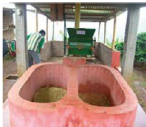
Tanque tina de concreto con esquinas internas redondeadas que evitan la acumulación de microorganismos no deseables.
