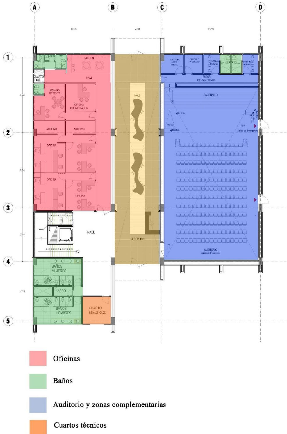
Figura 2. Planta arquitectónica primer piso.
