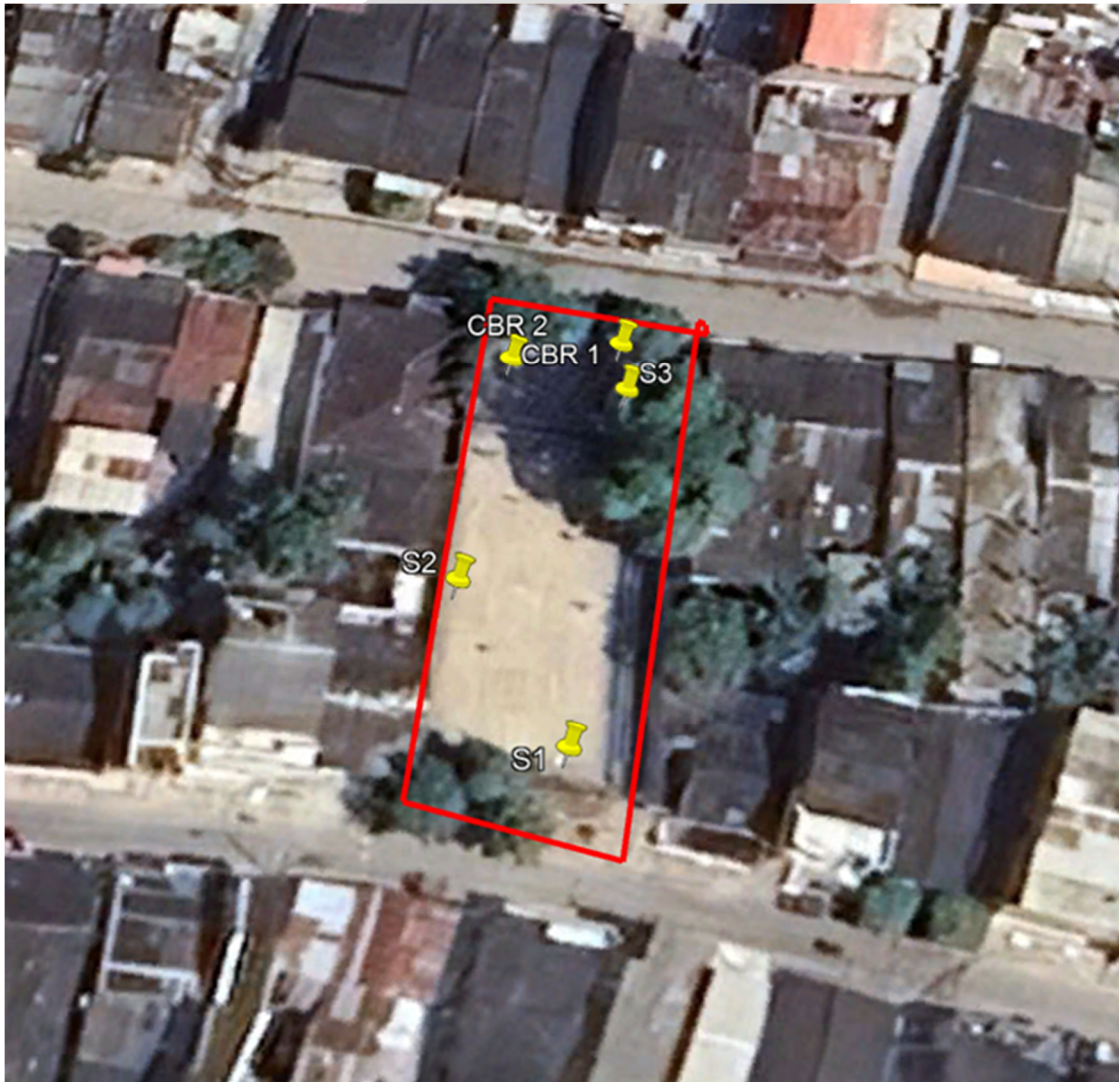
Ilustración 1. Localización de sondeos.
