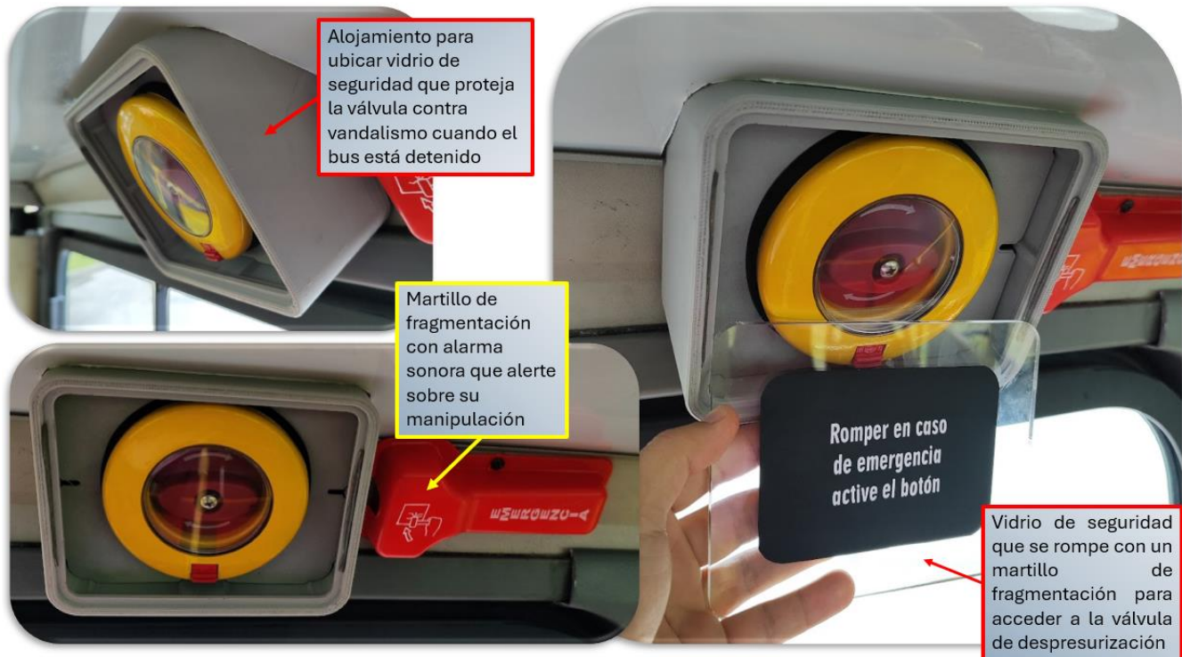
Ilustración 98: Protección adicional contra vandalismo - válvulas de despresurización de puertas.
