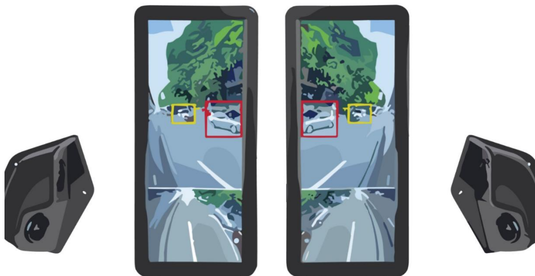
Imagen 15. Sistema retrovisores electrónicos y cámaras duales Fuente: TRANSMILENIO S.A.
