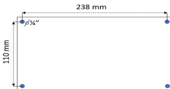
Imagen 02. Dimensiones del habitáculo batería auxiliar SIRCI
