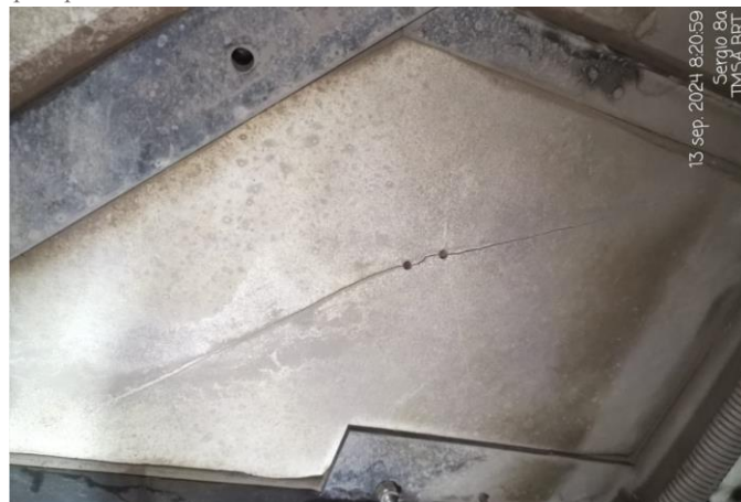
Ilustración 35: Fallas de materiales de piso por inadecuados diseños estructurales
