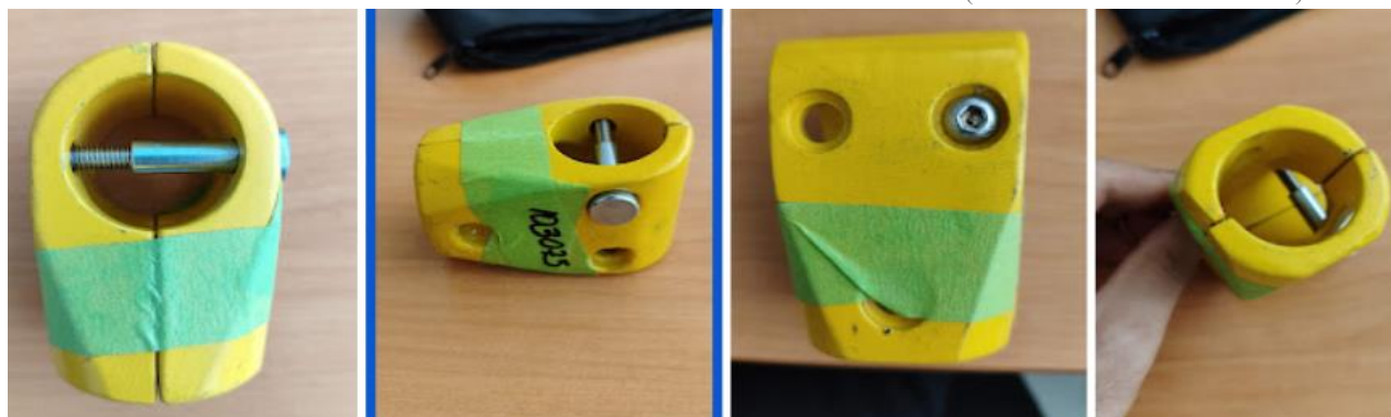
Ilustración 75: Sistema de unión de secciones de asideros en los vehículos (deben ser de aleación metálica)
