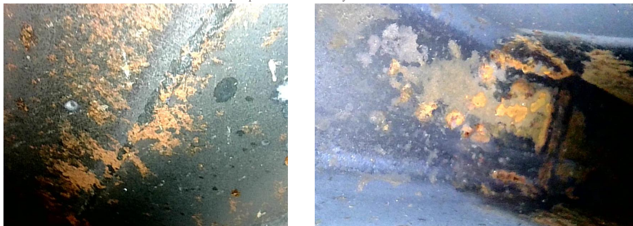
Ilustración 33: Afectaciones estructurales por presunta oxidación y corrosión en buses con menos de 5 años de servicio.
