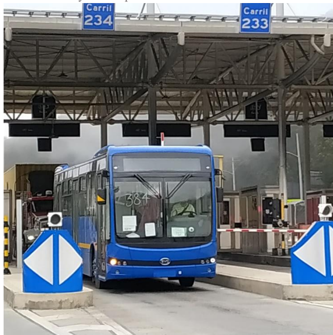
Ilustración 50: Pruebas dinámicas adelantadas con buses eléctricos en Mosquera - Cundinamarca, verificando en ruta desempeño dinámico y otras especificaciones funcionales – año 2020
