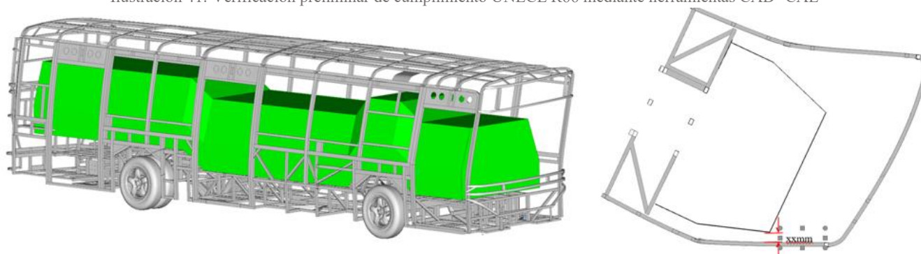
Ilustración 41: Verificación preliminar de cumplimiento UNECE R66 mediante herramientas CAD- CAE
