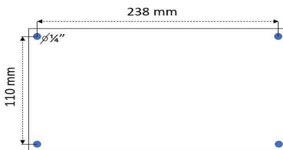
Imagen 02. Dimensiones del habitáculo batería auxiliar SIRCI
