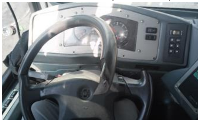
Ilustración 29: Volante de conductor roto por fallas de diseño y manufactura
