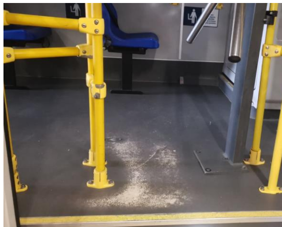
Ilustración 35: Fallas de materiales de piso por inadecuados diseños estructurales
