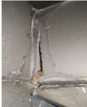
Ilustración 36: Falla estructural en chasis por presuntos defectos de manufactura
