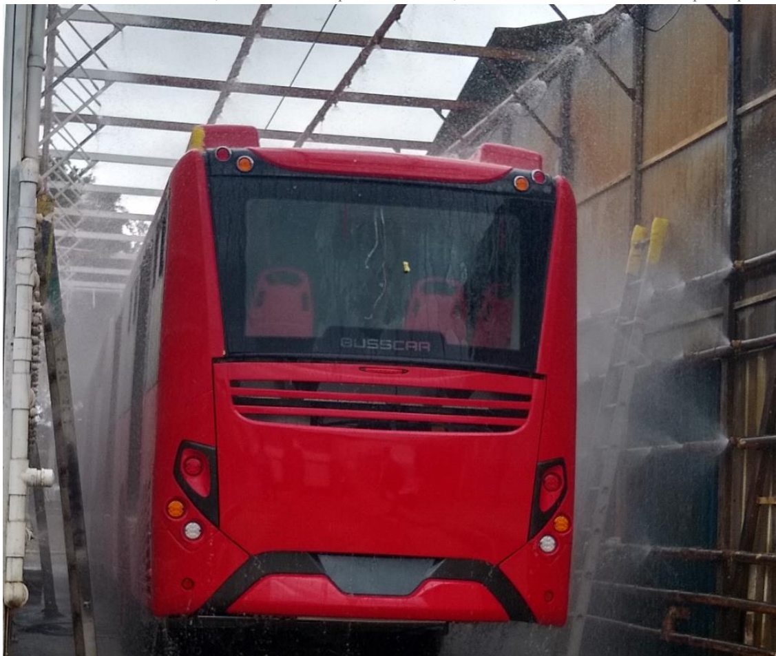
Ilustración 45: Pruebas FAT, como la de estanqueidad de cabina, se realizan también en esta fase de prototipos
