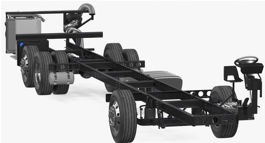
Ilustración 81: Típico ejemplo de chasis para carrozar buses de transporte de pasajeros, en este caso de tipo escalera
