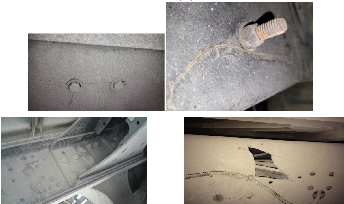
Ilustración 28: Fisuras en puente transversal y soportes laterales bastidor del chasis
