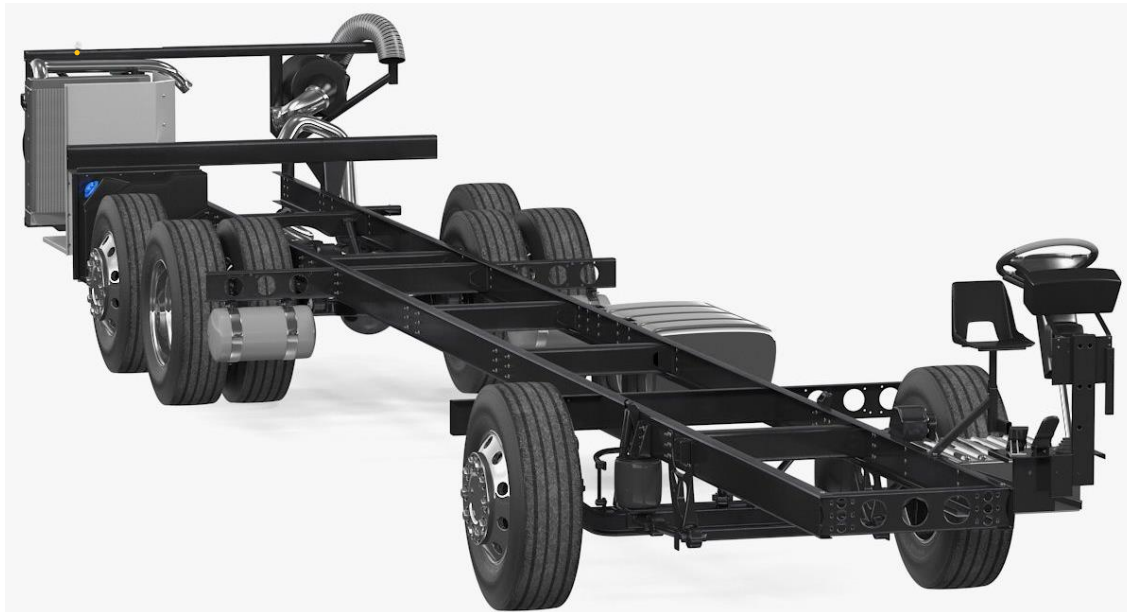
Ilustración 61: Típico ejemplo de chasis para carrozar buses de transporte de pasajeros, en este caso de tipo escalera
