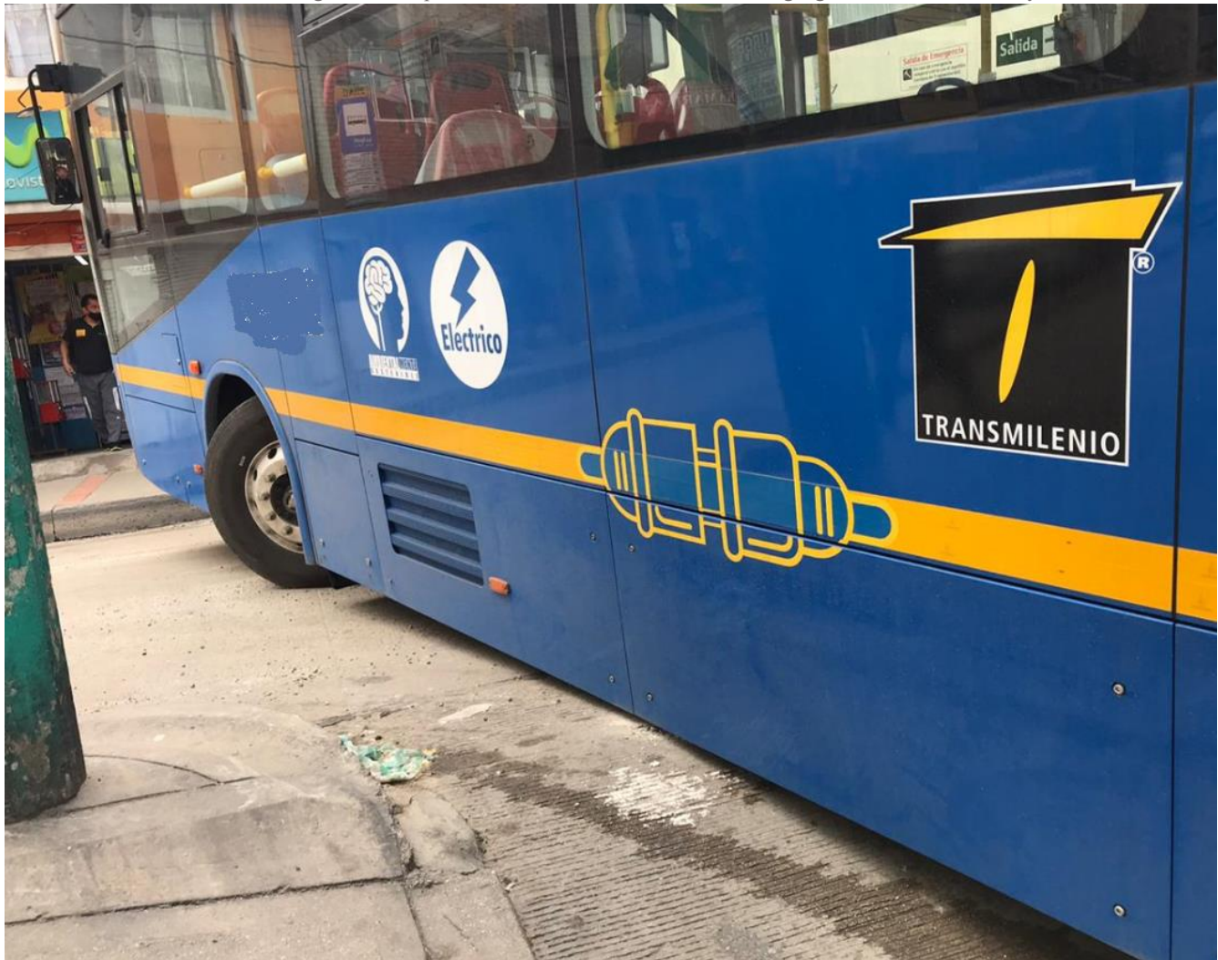
Ilustración 32: Afectaciones al ángulo ventral por falta de reconocimiento del contexto geográfico antes de diseñar y fabricar vehículos
