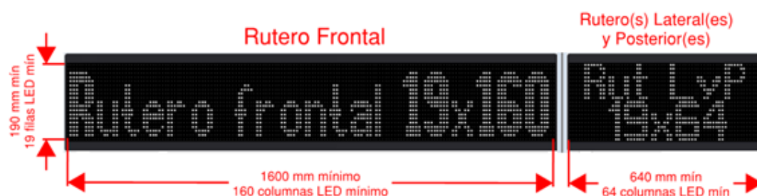
Figura 5. Especificaciones dimensionales de ruter
