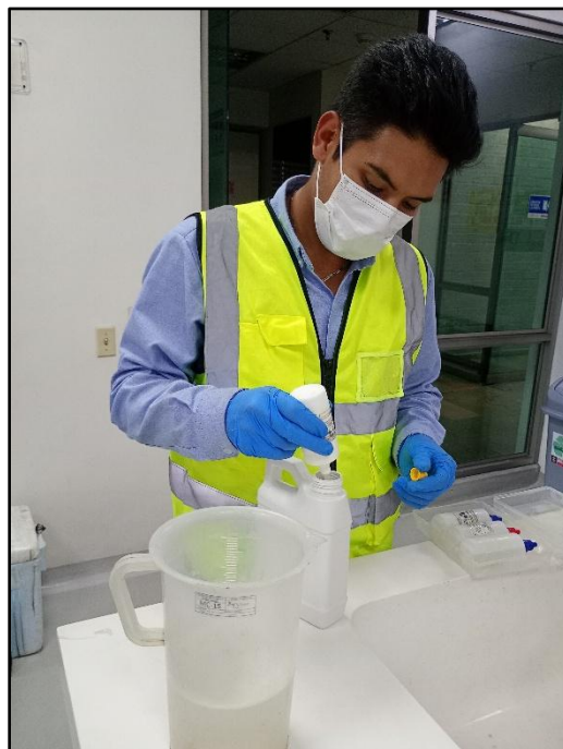
Fotografía 4. Medición Solidos Sedimentables.
