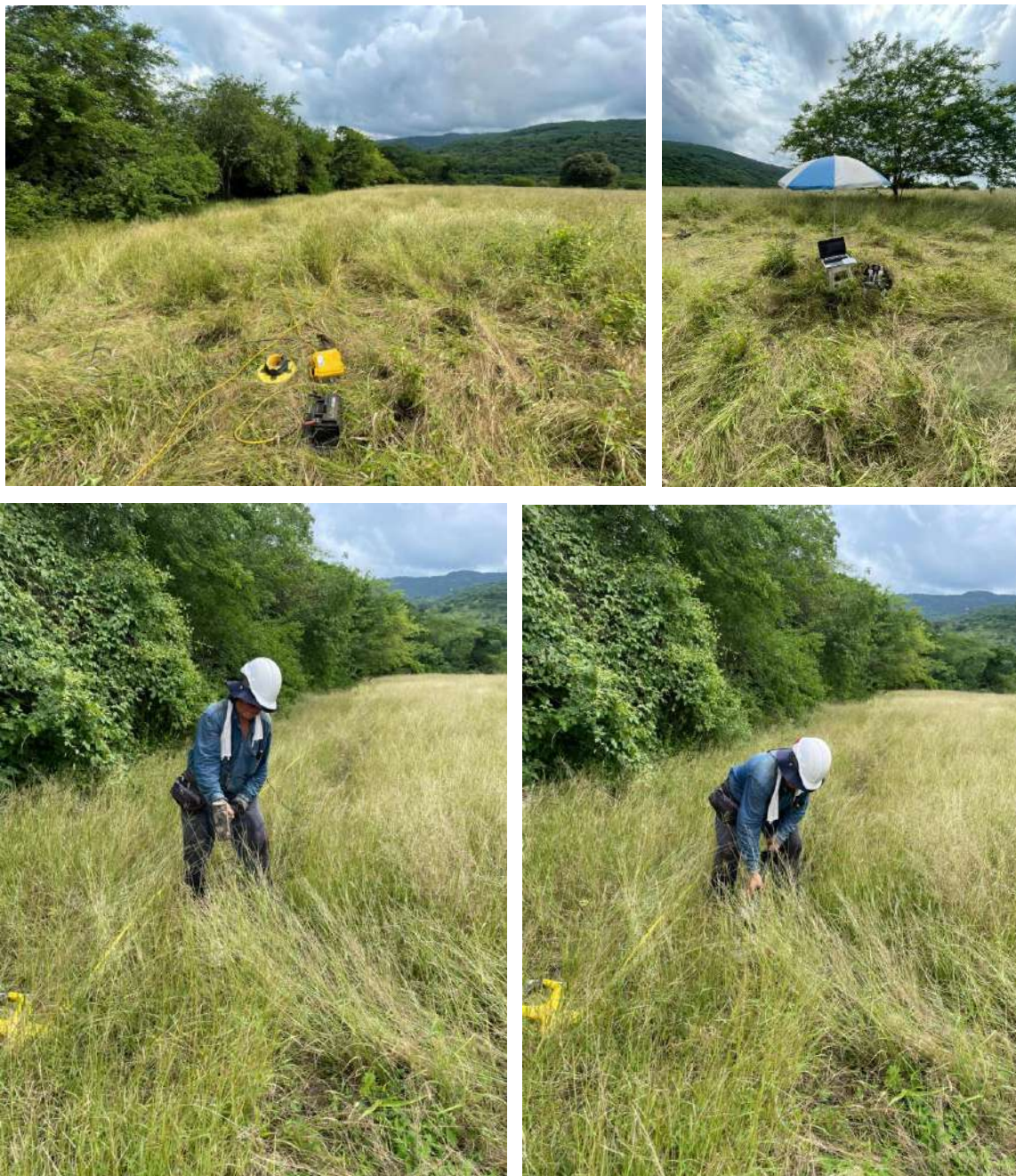
Figura 13. Registro fotográfico Líneas de refracción sísmica Punto crítico No 09
