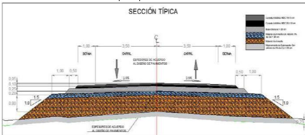
Ilustración 2 Sección transversal típica aprobada
