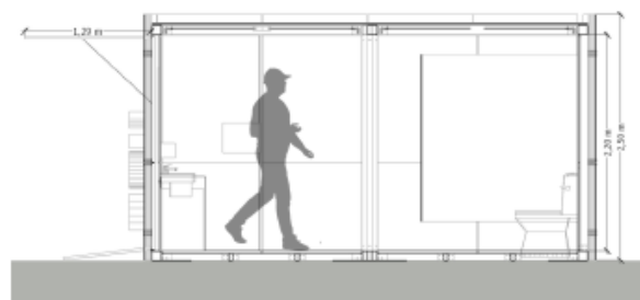
CORTE LATERAL DEL MÓDULO DE BAÑOS
