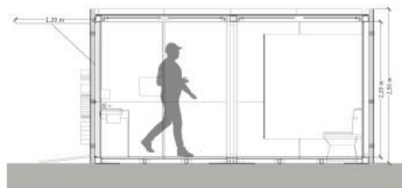
CORTE LATERAL DEL MÓDULO DE BAÑOS
