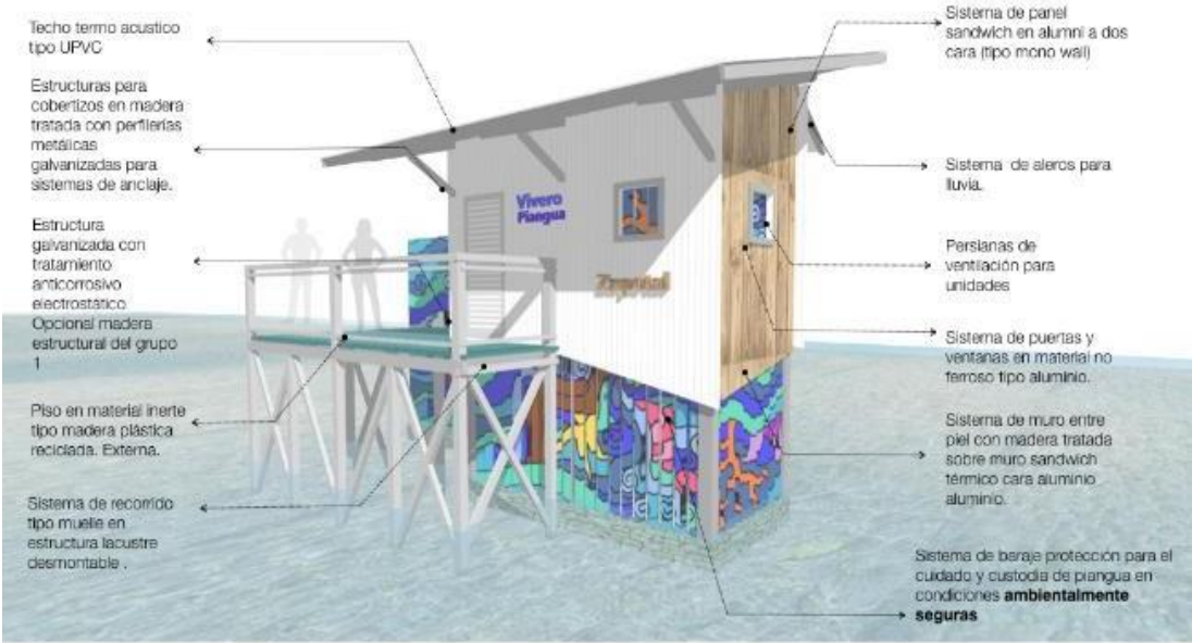
Imagen 6. Render de diseño, con indicación de materiales, para el vivero de piangüa
