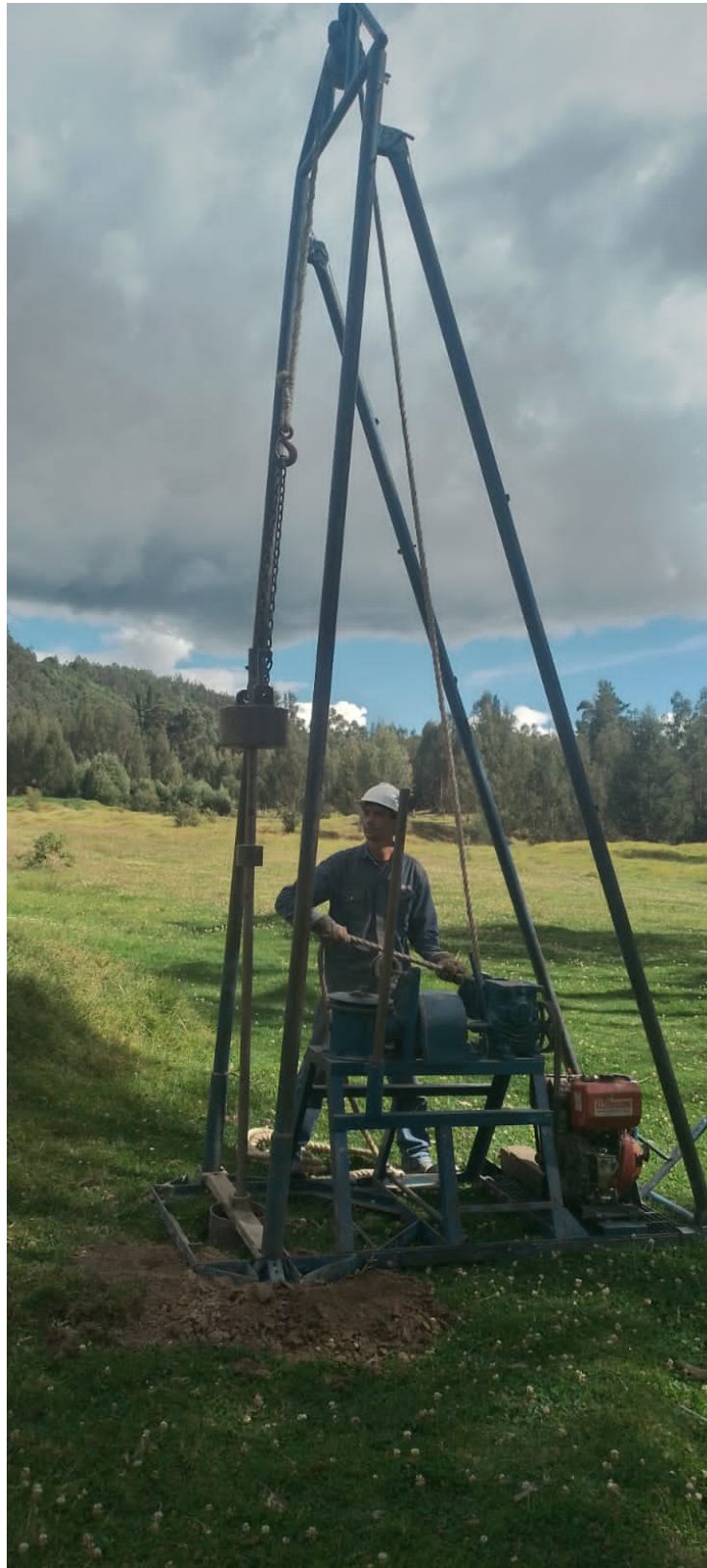
Fotografía 7. Sitio donde se realizó el sondeo 6 para toma de muestras y pruebas de resistencia in situ
