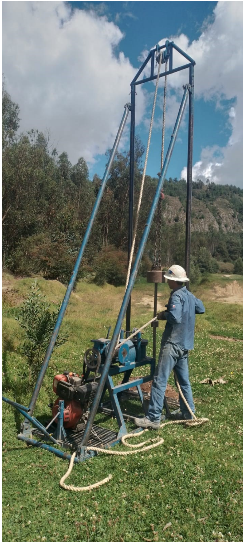
Fotografía 9. Sitio donde se realizó el sondeo 3 para toma de muestras y pruebas de resistencia in situ.
