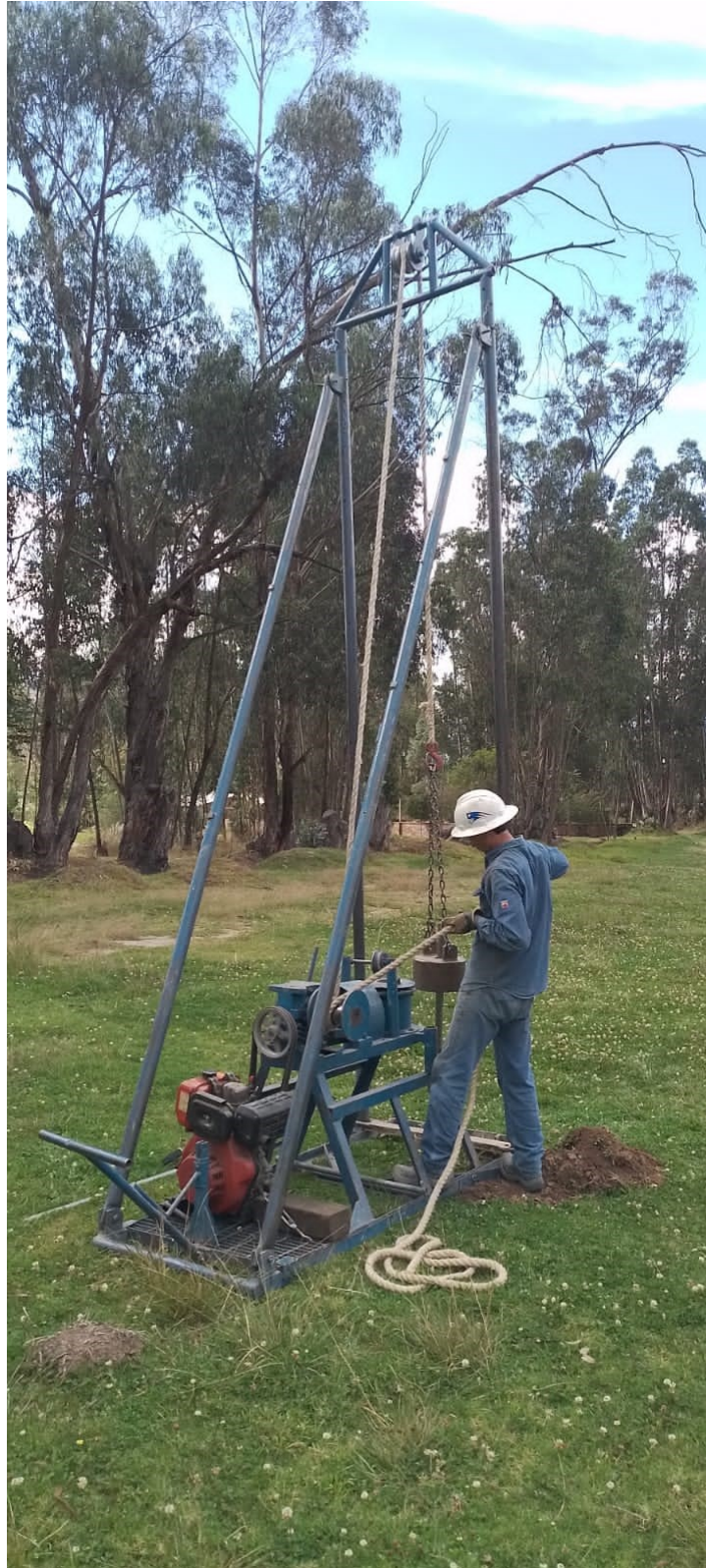
Fotografía 4. Sitio donde se realizó el sondeo 7 para toma de muestras y pruebas de resistencia in situ
