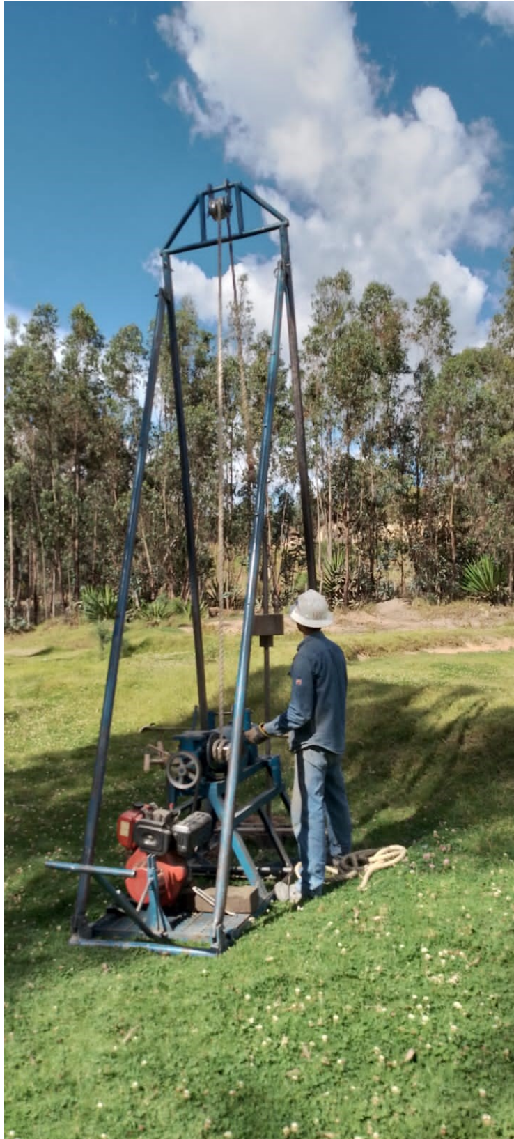
Fotografía 6. Sitio donde se realizó el sondeo 9 para toma de muestras y pruebas de resistencia in situ.
