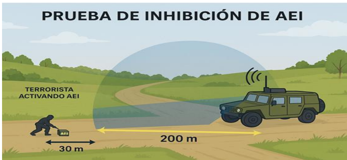
Ilustración 2: Imagen aproximada de la prueba para equipos inhibidores de señal tipo convoy
