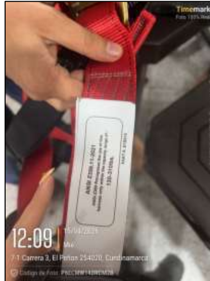
Fotografía 11. Inspección a Elementos de Protección Personal para trabajo en alturas
