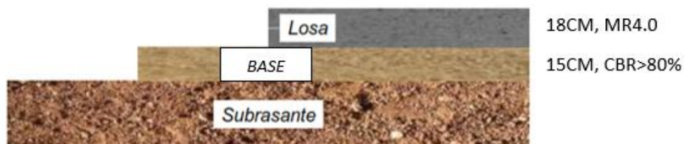
Estructura de pavimento diseño 2.
