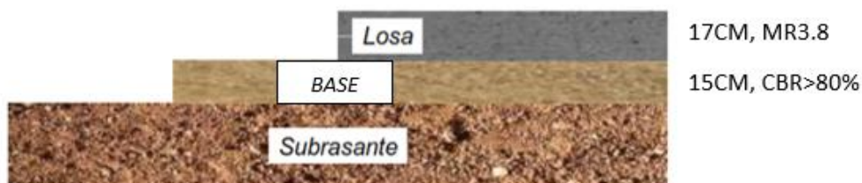
Estructura de pavimento diseño 1.
