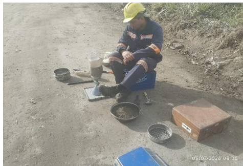
Vaciado del cono
