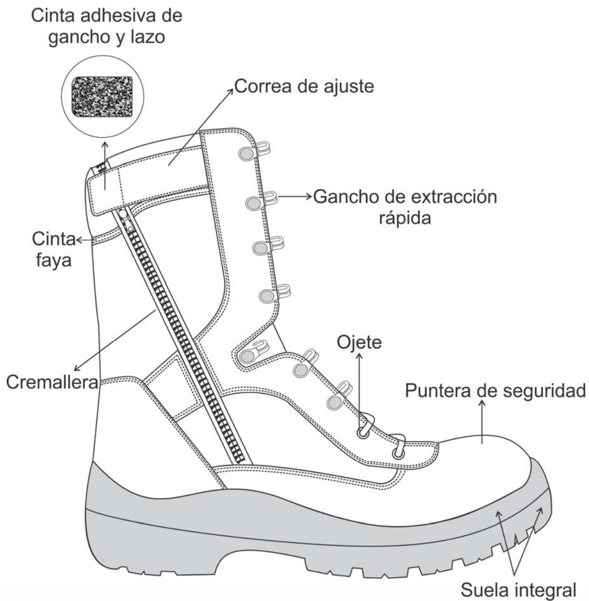
Figura 1. Vista ilustrativa lateral interno de la bota de seguridad y componentes
