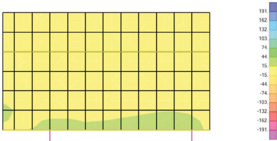
Figura 35: Chequeo de cortante 1-3.
