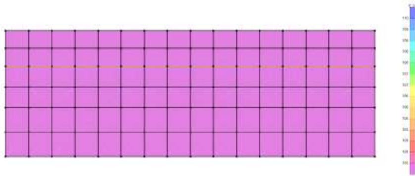
Figura 89: Chequeo de acero Ast1 top. 1#4 c/.125m
