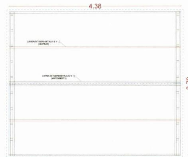
ESTRUCTURA METALICA CUBIERTA - PASILLO SECCION2
