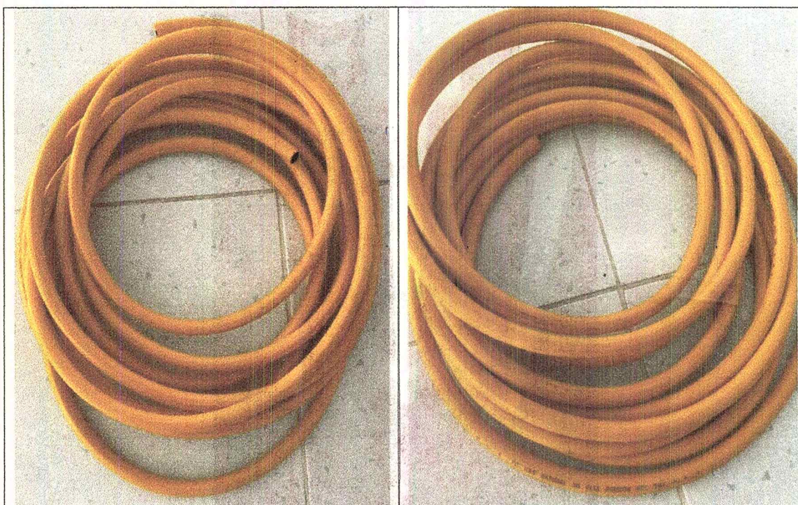
Fotografía 6 y 7: Una (1) Manguera a gas 3/8" para gas propano por 10 metros.
