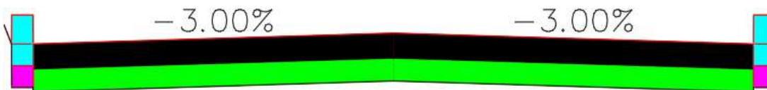
Figura 7. Sección típica de la vía en estudio.
