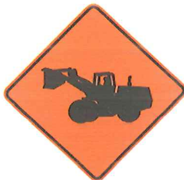
Imagen No. 5 SPO-02. Maquinaria en la Vía.
