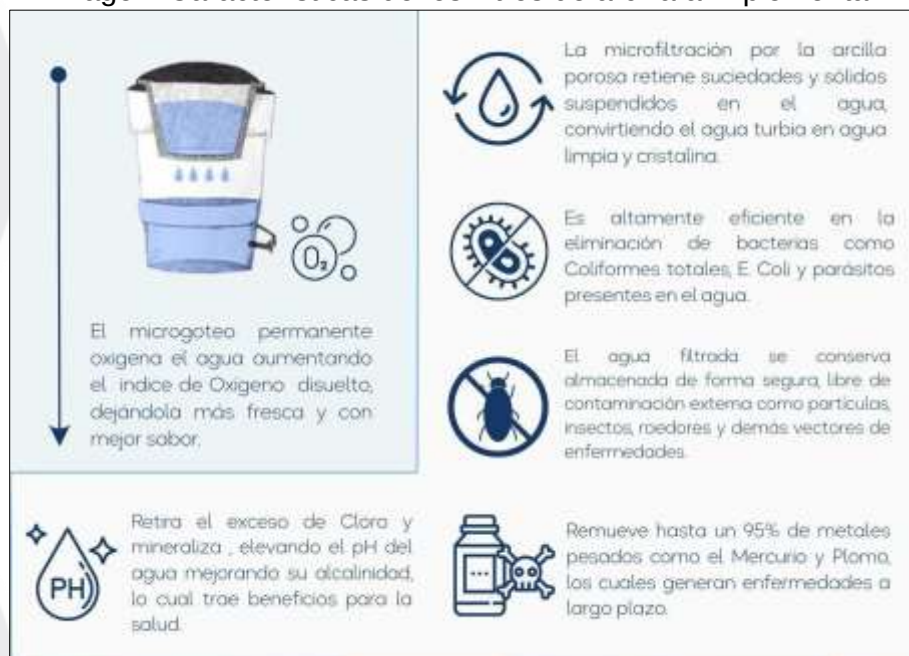
Imagen. Características de los filtros de arcilla a implementar.
