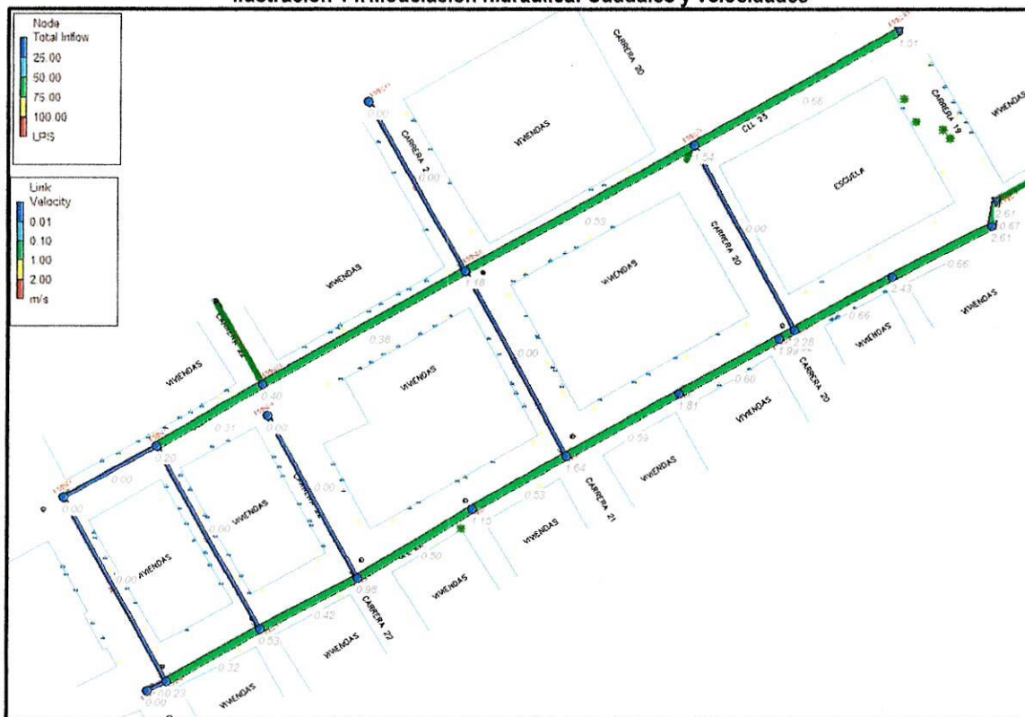
Ilustración 14. Modelación hidráulica: Caudales y velocidades
