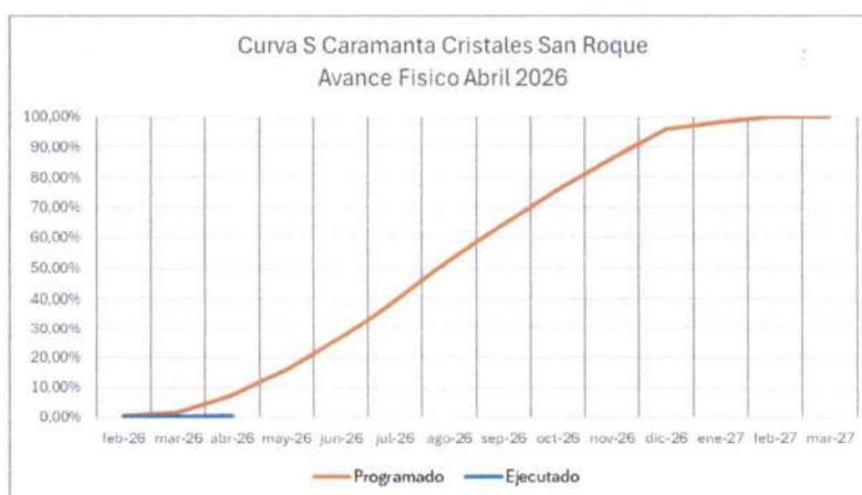
Ilustración 5. Seguimiento a la curva S de avance físico del corredor Caramanta – Cristales – San Roque
