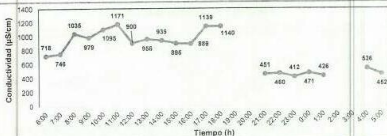
Ilustración 4 Variación Conductividad Entrada – PTAR
