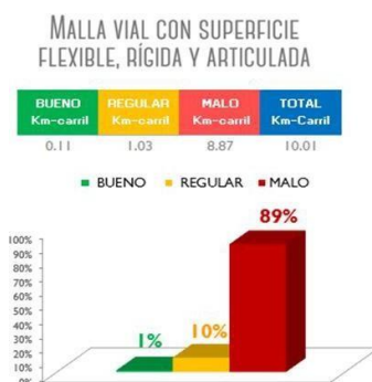
Ilustración 8. Estado de la malla vial rural NO PRINCIPAL con estructura de pavimento en la Localidad de Sumapaz. Fuente: Sistema de información geográfica –SIGIDU-. Enero de 2025.
