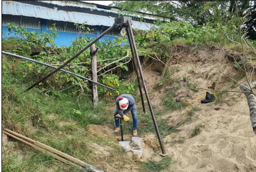
Foto 4. Sondeo exploratorio S-02 – Ensayo SPT
