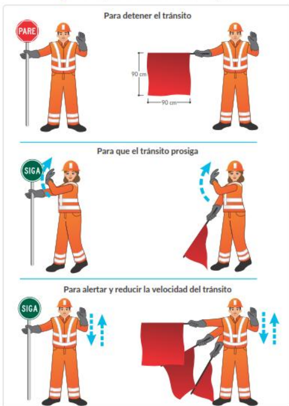
Figura 7-24. Operaciones con indicaciones PARE y SIGA
