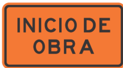
Ilustración 5 SIO-02 INICIO DE OBRA (Fuente: Manual de Señalización 2024)
