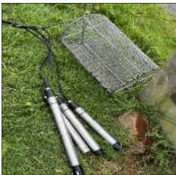
Imagen No. 7 Ejemplo sondas de medición estación tipo II
