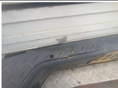
RAYON EN EL ESTRIBO TRASERO
