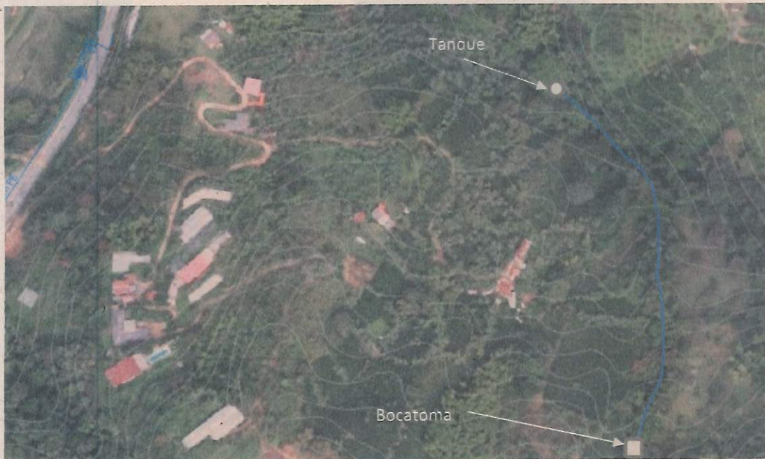
Imagen 4. Conducción Abasto Vereda Maracas Fuente – Elaboración propia – SIG Aguas de Manizales S.A. E.S.P. – BIC
