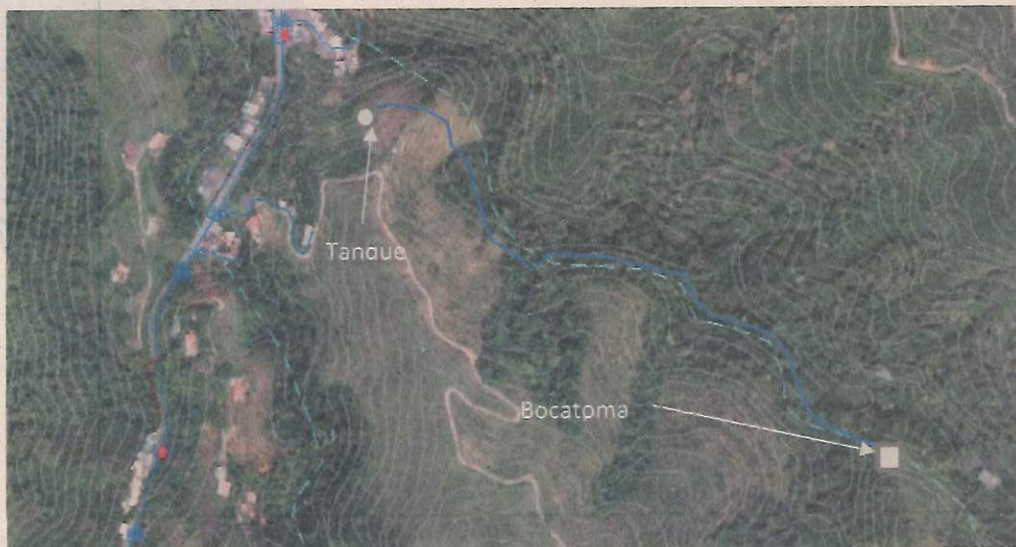
Imagen 5. Conducción Abasto Vereda El Aguila Fuente – Elaboración propia – SIG Aguas de Manizales S.A. E.S.P. – BIC
