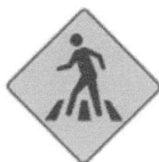
SP-46A PROXIMIDAD DE CRUCE PEATONAL
