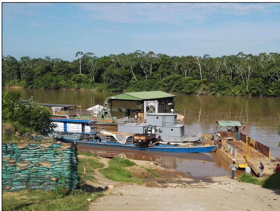
BARCAZAS QUE PUEDEN TRANSPORTAR ALREDEDOR DE 40 TONELADAS DE PESO EN MATERIAL
