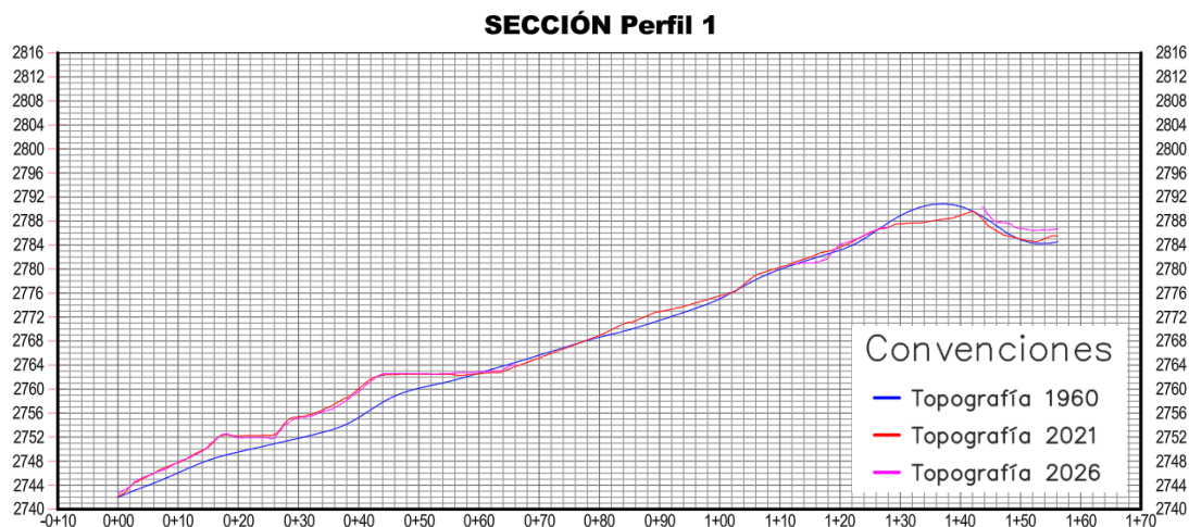
Figura 7-6. Perfil 1 de contrastación topográfica
