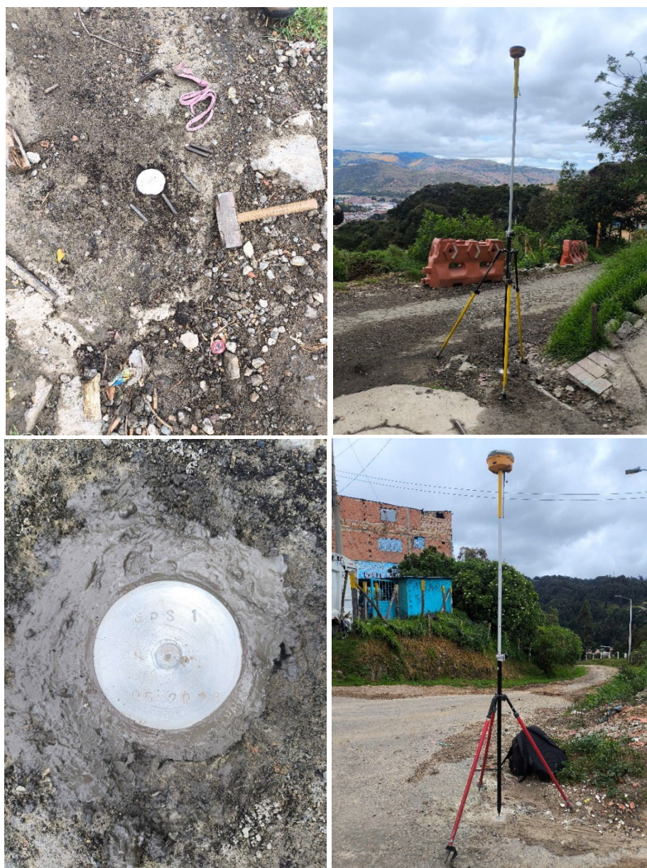
Figura 3-1 Materialización de puntos de control geodésico en el Polígono 1
