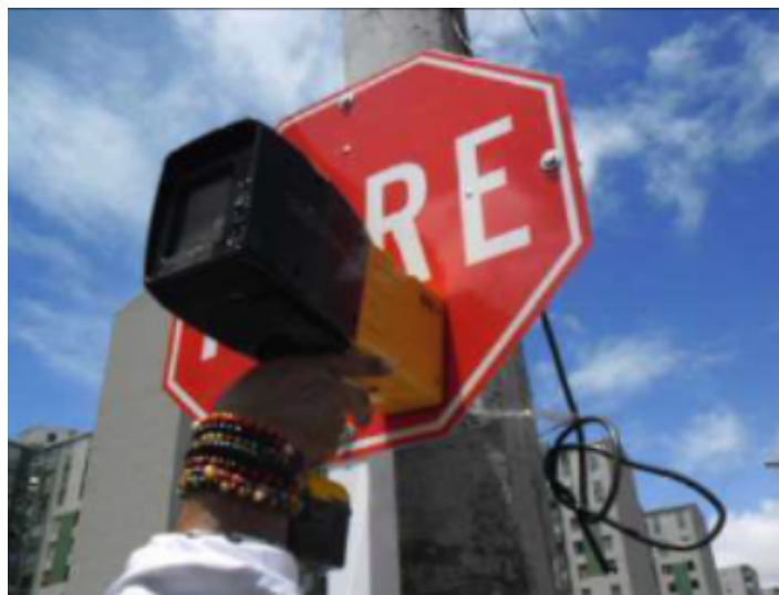
Figura 4: Toma de retrorreflexión a señales verticales
