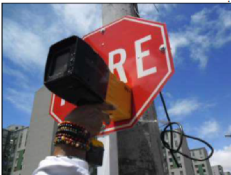
Ilustración 4. Toma de retroreflexión a señal vertical de pedestal
