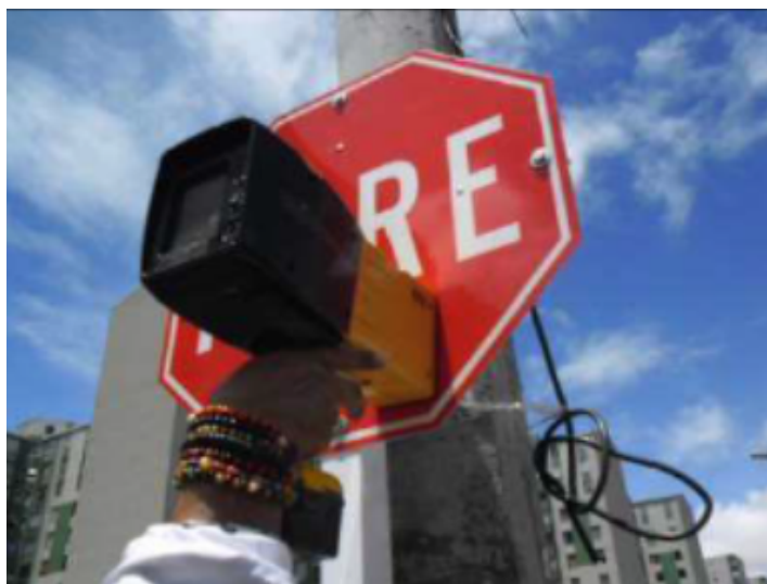
Figura 4: Toma de retrorreflexión a señales verticales
