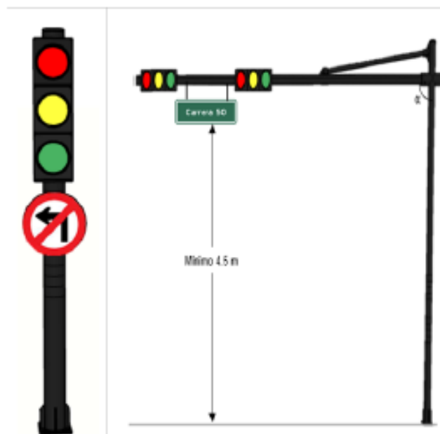
Figura 6: Ubicación de los tableros sobre ménsula y/o poste
