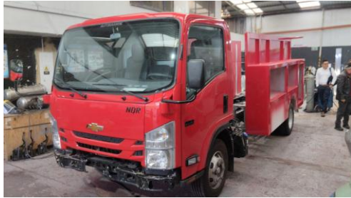
Máquina cisterna Chevrolet NQR: cabina terminada y carrocería en fabricación
