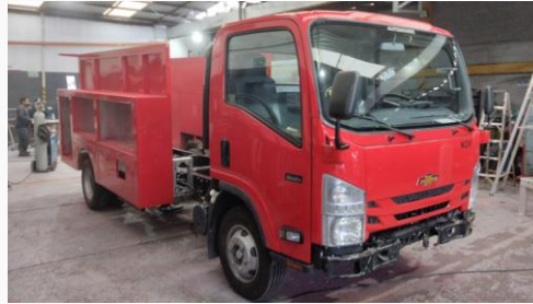
Carrocería con módulos y compartimentos laterales en proceso
