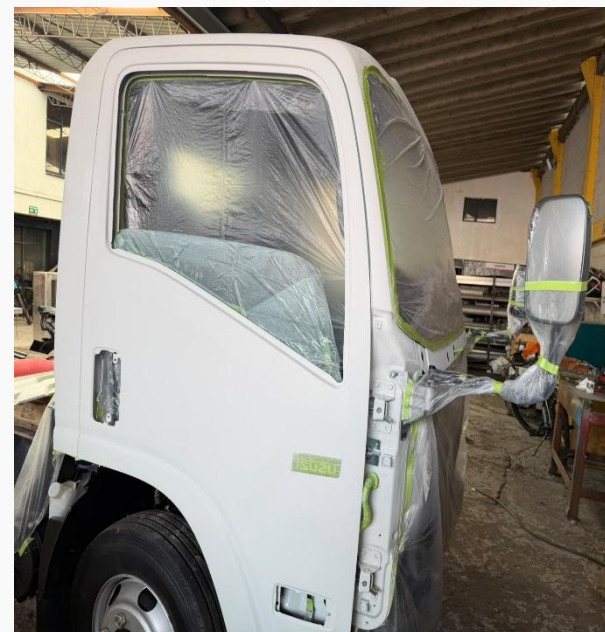
Cabina NQR en alistamiento final de pintura
