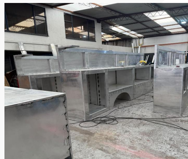
Carrocerías en distintas etapas de fabricación.
