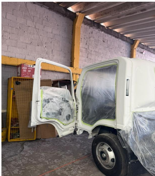
Cabina en proceso de acabado, puerta enmascarada
