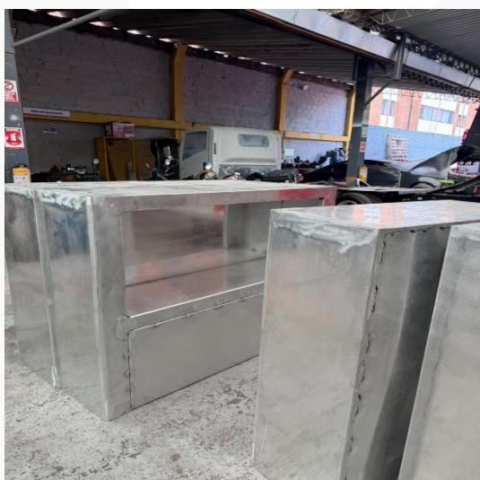
Compartimentos en aluminio en proceso de soldadura
