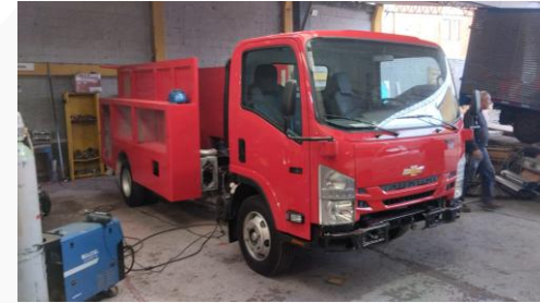
Vista lateral: estructura de carrocería y compartimentos instalados sobre chasis NQR
