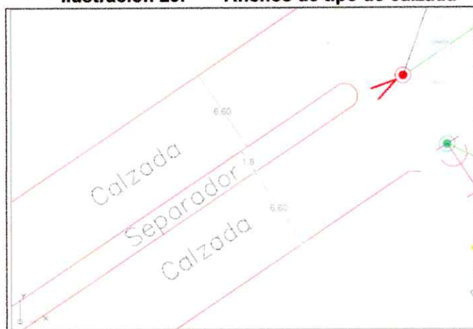
Ilustración 23. Anchos de tipo de calzada
