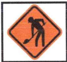
SPO-01 Trabajos en la vía.
