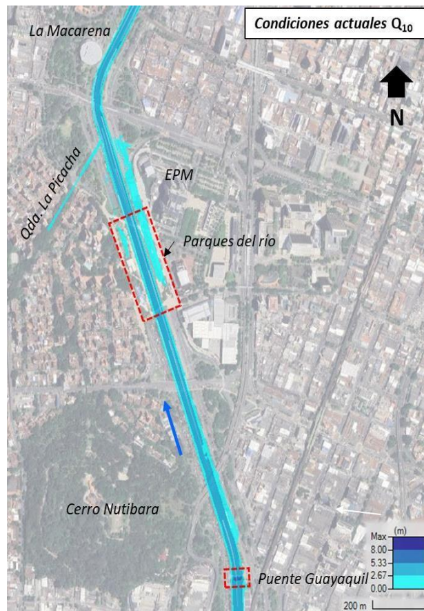
Figura 31. Mancha de inundación asociada a Q_{10} , Tramo Puente Guayaquil - Industriales.
