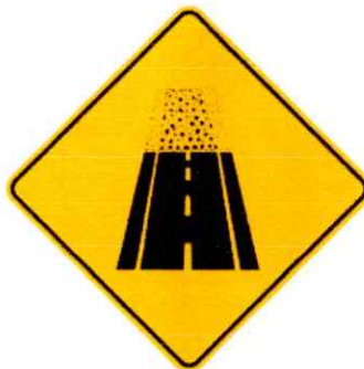
Ilustración 27 Final del pavimento
